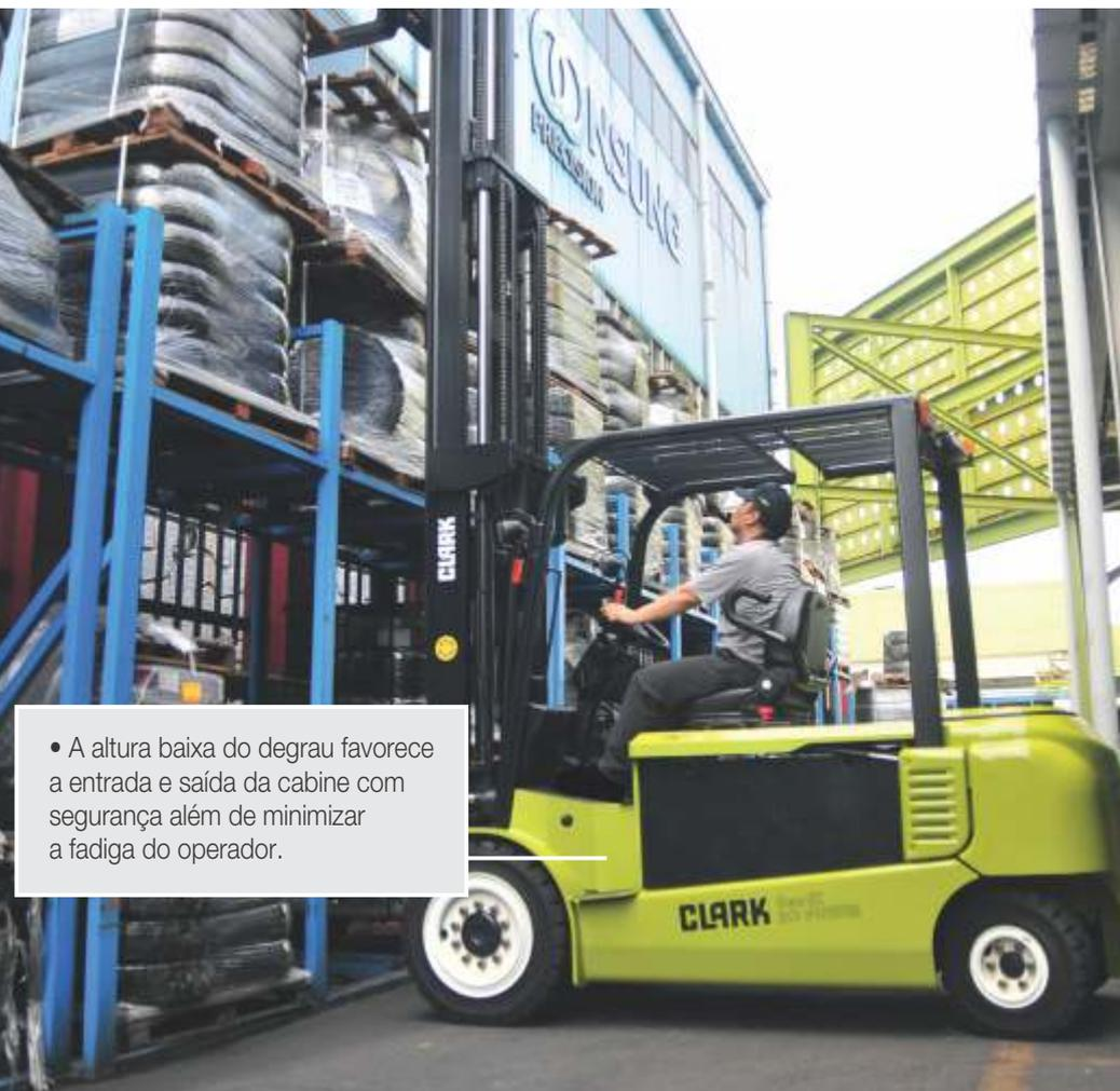
• A altura baixa do degrau favorece a entrada e saída da cabine com segurança além de minimizar a fadiga do operador.
